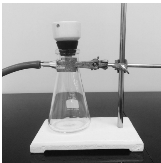
Figure 2: Assemblaggio dell'apparecchiatura per la filtrazione sotto vuoto.
