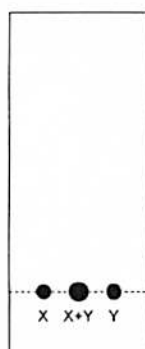
Fig. 1.1 Macchie su lastra TLC prima dello sviluppo; X: 1,4-DHP, Y: miscela di reazione.
