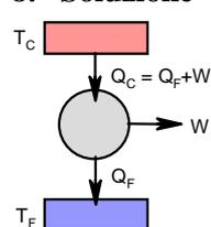
Il calore prelevato dal serbatoio caldo ( $Q_C$ ) in parte è trasformato in lavoro W, in parte è ceduto al serbatoio freddo ( $Q_F$ ). Quindi:  $Q_C = Q_F + W$  da cui:  $Q_F = Q_C - W$ .
