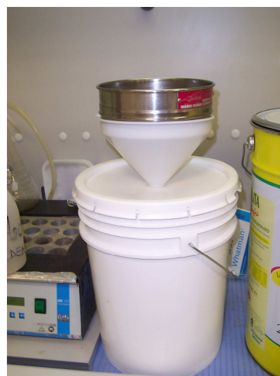
Figura 25 - Filtrazione olio fritto
