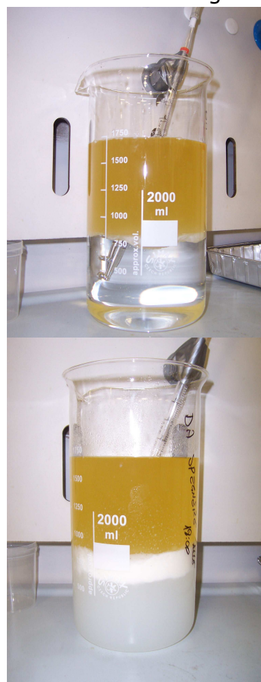
Figura 9 - 10 - Impianto per purificazione del Biodiesel all'inizio e durante
