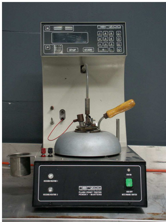
Figura 16 - Pensky Martens per la determinazione del punto di infiammabilità a vaso chiuso
