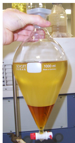
Figura 8 - Separazione delle due fasi: sopra il biodiesel e sotto la glicerina
